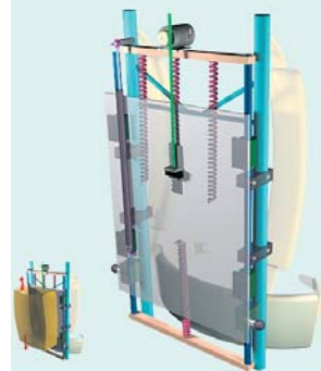
Gefedert. Beim Gehen bewegt sich die Last an Federn und treibt den Generator an. Foto Science
